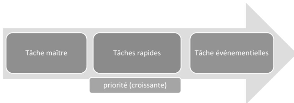
Figure III.5 : Priorité des tâches d'un API multi-tâches
