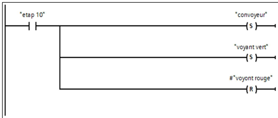
Figure 4.16 : Mise en marche du convoyeur et les voyants
