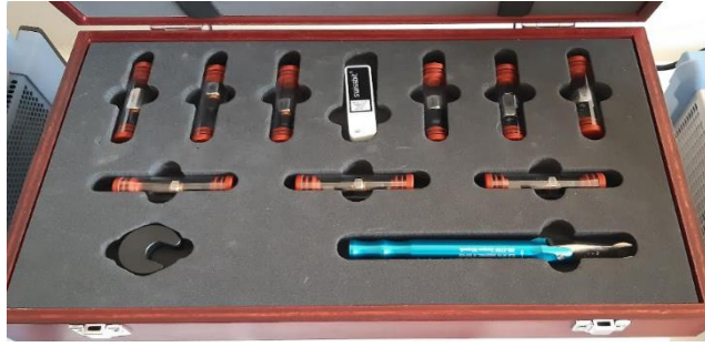
Figure 3.27 : kit de calibration du VNA.
