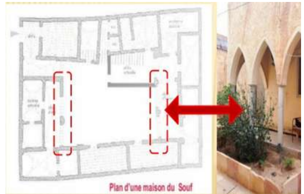
Figure 10 les galerie d'une maison de Souf
