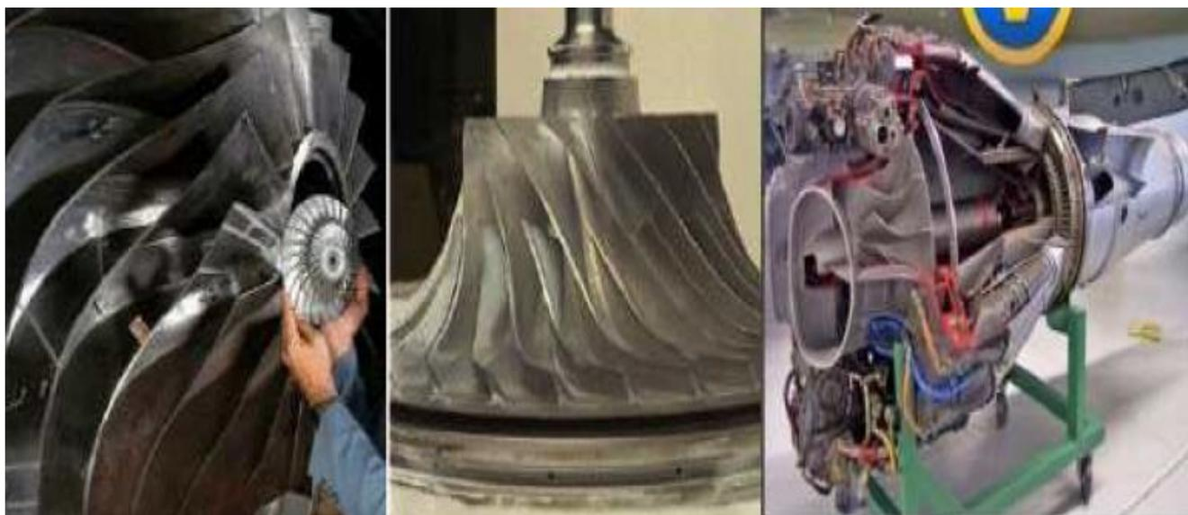
**Figure (2.3) :** Compresseur radial (centrifuge). [25]
