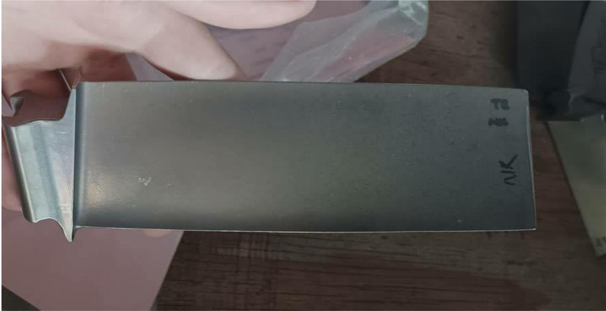
**Figure(4.1) :** Aube de deuxième étage de compresseur.
