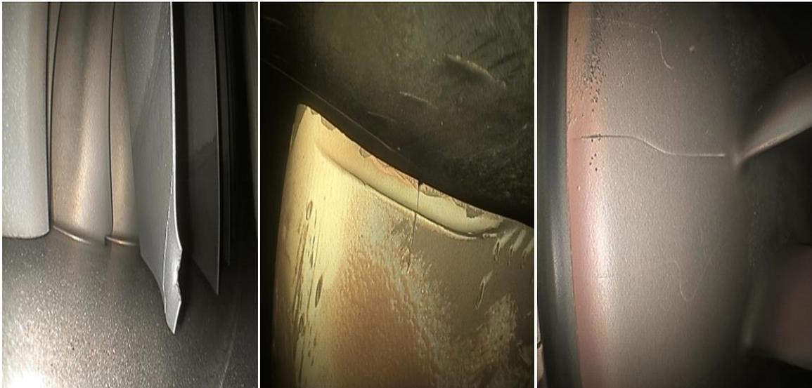
**Figure (2.8) :** Endommagement par fatigue dans un compresseur.
