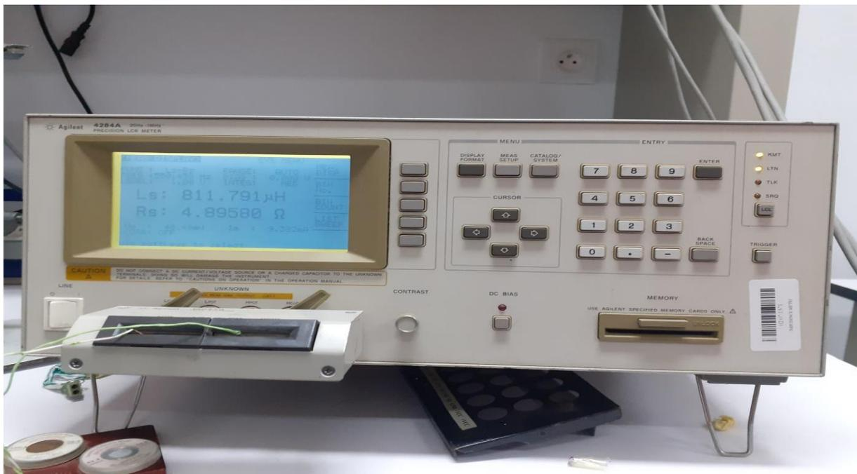
Figure (4.11) : L'appareil hpagilent LCR mètre.
