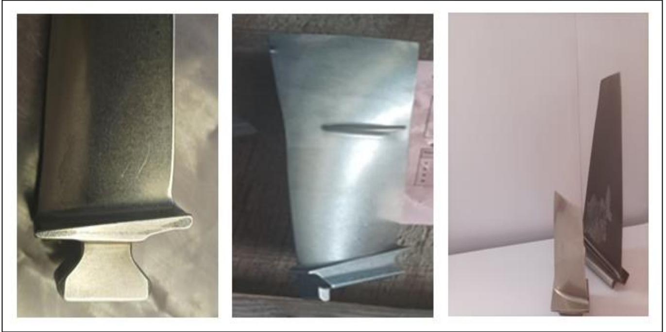
**Figure (2.5) :** Les aubes de compresseur.
