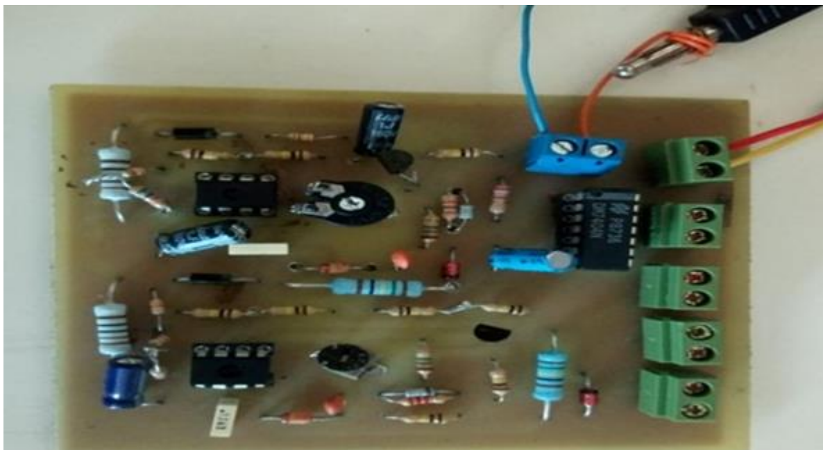
Figure 4.8 : La carte électronique de circuit de contrôle MLI complété.
