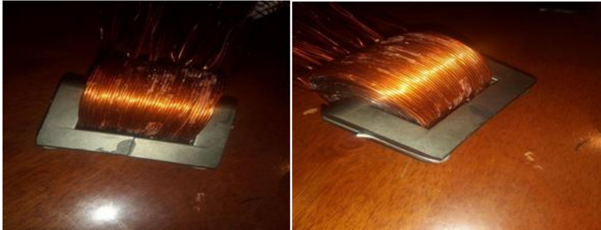
Figure 4.14 : Le transformateur réalisé.
