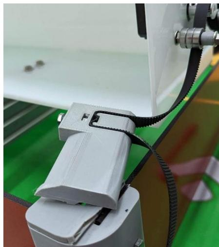
*Figure III-20 support de courroie brisé*
