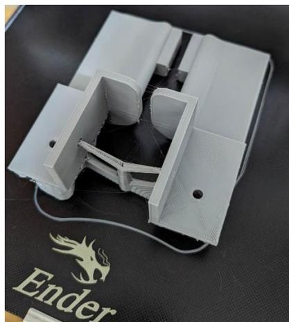
*Figure III-19 support de courroie imprimé en plastique*
