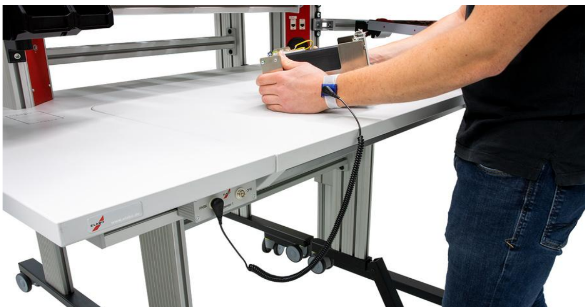
Figure 4.3 : Un bracelet ESD fonctionnel et relié à la terre [11]
