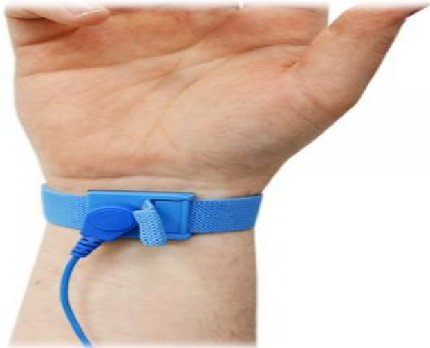
Figure 4.2 : Un bracelet en contact avec la main de l'opérateur [3]
