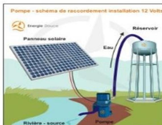
Figure II.11 : pompe solaire de surface.[8]
