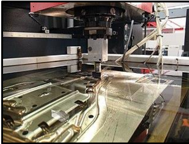
Figure I.21 : Une machine à décharge électrique
