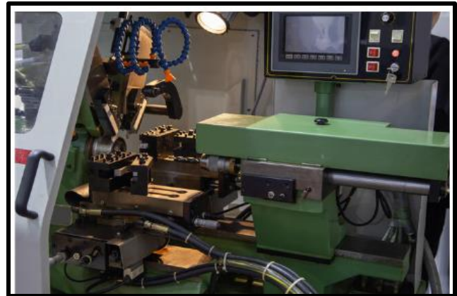
Figure I.18 : Machine de tour hydraulique CNC alésage perçage pièce
