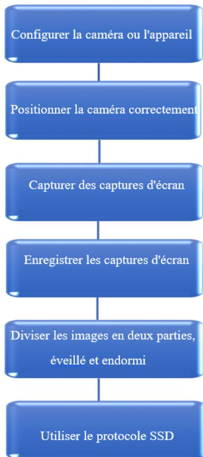
Figure 16 : diagramme des étapes d'acquisition d'images
