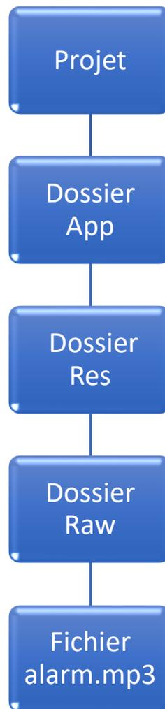
**Figure 24 :** Diagramme de l'implantation de l'audio sur Android Studio
