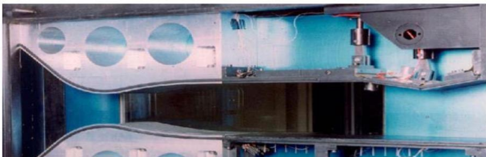
Figure I-8: Tuyère d'une soufflerie supersonique.
