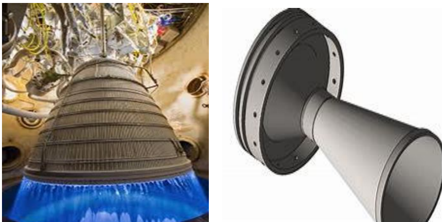
Figure I-7: Tuyère propulsive d'un moteur fusée
