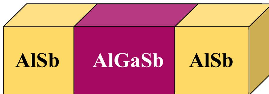
Figure 2.1. Schéma de la structure à puits quantique AlGaSb/AlSb.
