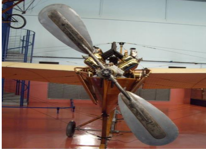
Figure I-8 : Hélice métallique de l'Antoinette du musée de l'Air du Bourget.
