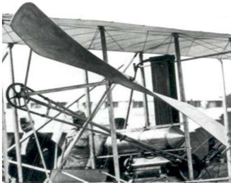
Figure I-2 : Un gros plan de l'une des hélices et du mécanisme qui l'alimentait.
