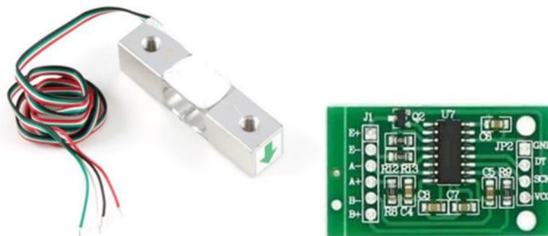
Figure IV-9 : Capteur de force et son module électronique [20].
