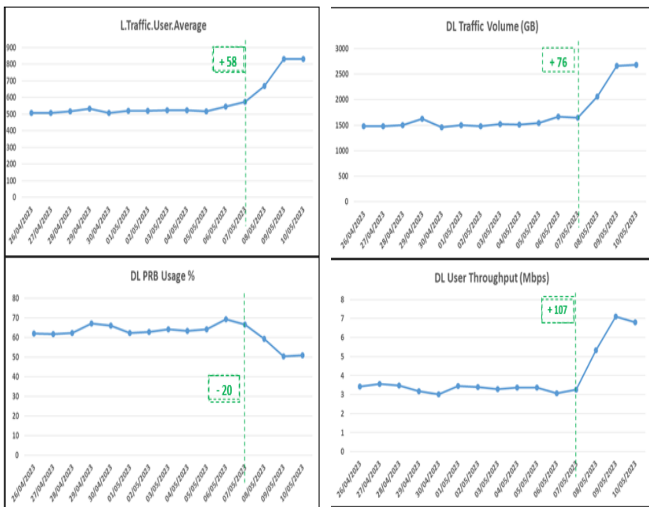
Figure 4- 31: Implémentation de TDD 8T8R et Massive MIMO.
