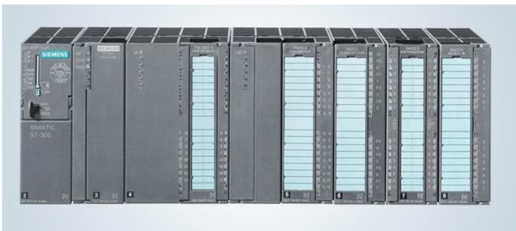
Figure 4.2 : Structure externe d'un automate programmable industriel
