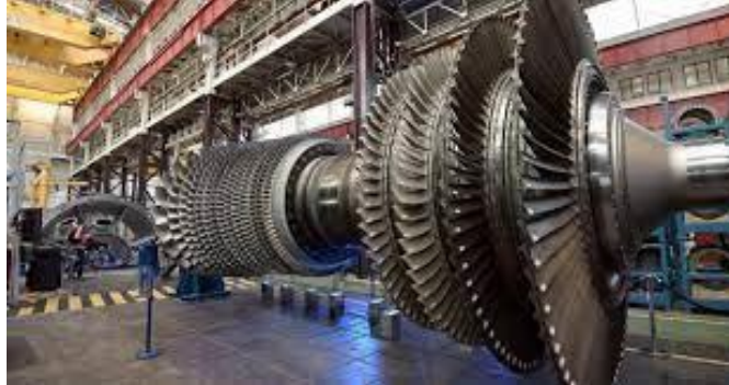
Figure 2.9 : Turbo-alternateur d'une centrale électrique
