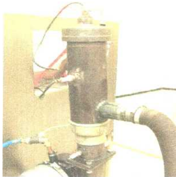
Figure 4-26 : la chambre montée sur le turbo.
