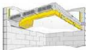
Fig 1 : rotation mécanique des dalles par la "roche au feu" entre la dalle et le faux plafond
