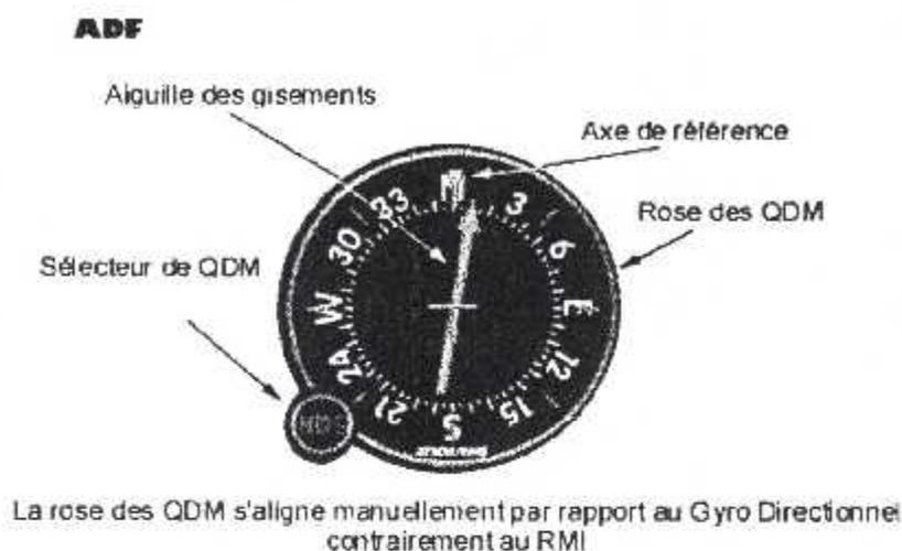
fig. I-11 : Le Radiocompas
