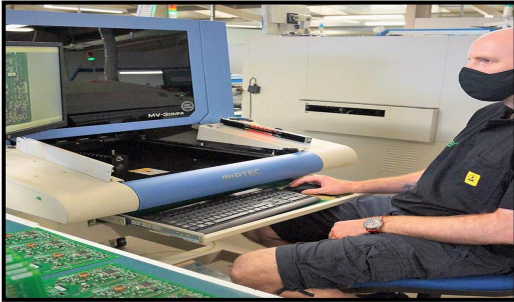
Figure Error! No text of specified style in document..13. Inspection Automatisée Optique (AOI)
