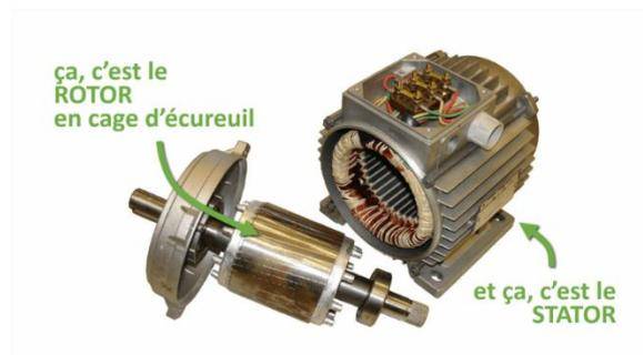
**Fig(1.4) :** Machine asynchrone à rotor cage d'écureuil
