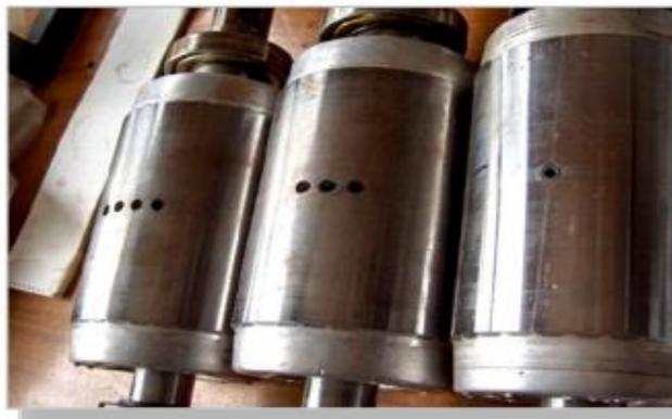
*Fig.1.8 Défaut de rupture de barres artificiel*
