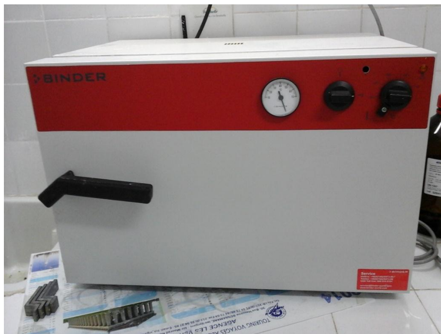
Figure 54: Etuve de séchage E28 BINDER (photo originale)
