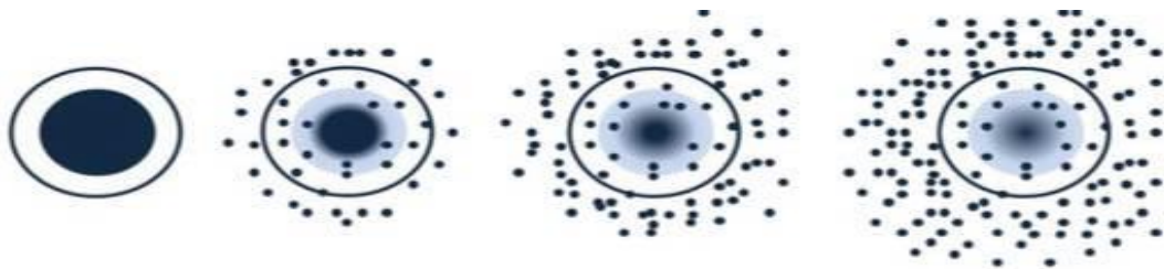
Figure 1.5 : Mécanisme de contrôle de la libération d'un principe actif par diffusion avec système réservoir. [13]
