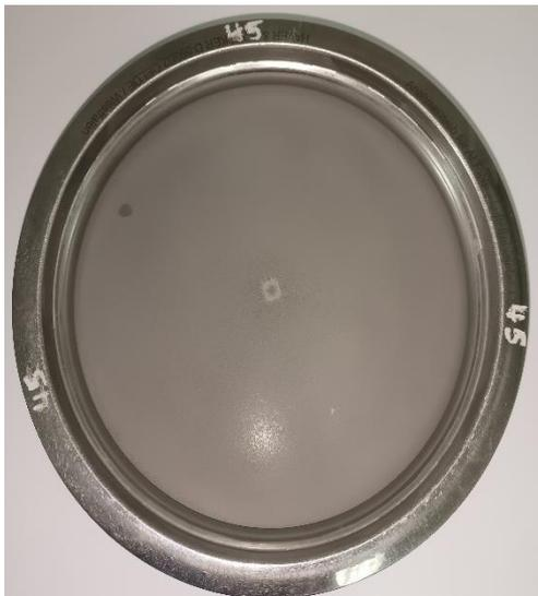
**Fig. 2-8 :** Tamis 45 $\mu\text{m}$
