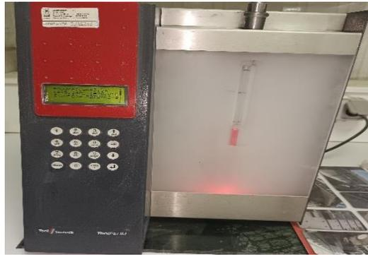
**Fig. 2-10 : Perméabilimètre BLAINE**
