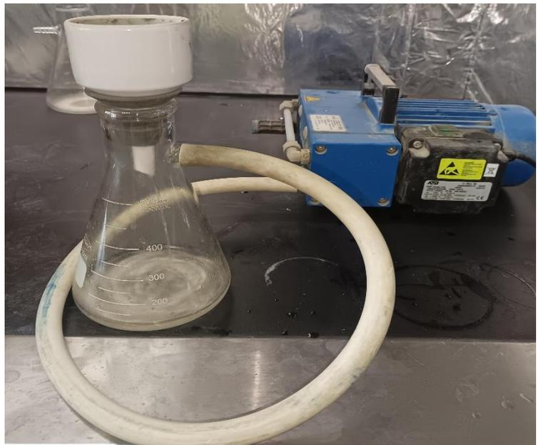
**Fig. 2-3 :** Filtration de la solution sous vide
