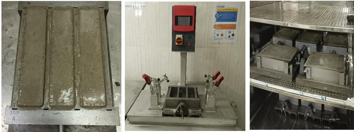
**Fig.2-12 : Moulage des éprouvettes**
