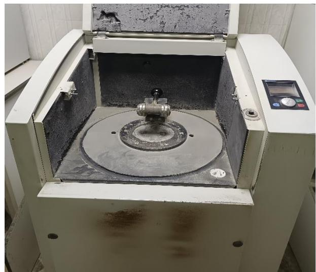
**Fig. 2-1 : Broyeur à disque**
