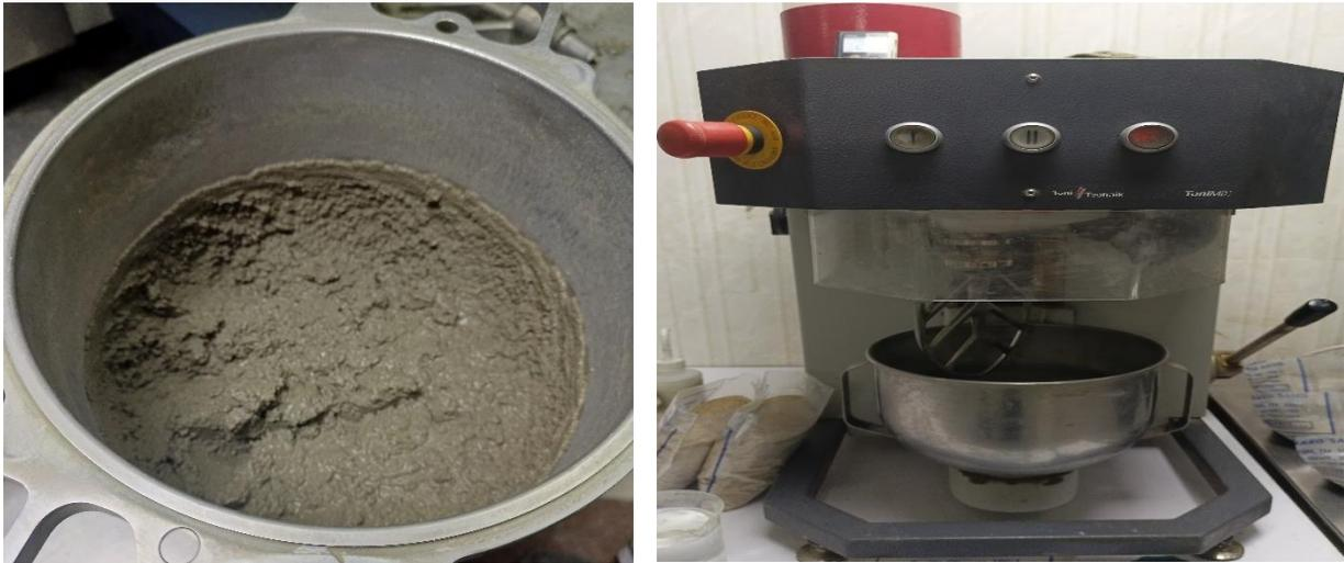
**Fig.2-11** : Préparation du mortier
