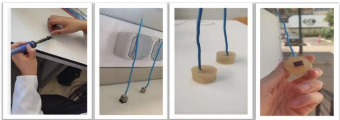
**Figure 2.4.** Les étapes de préparations d'échantillon
