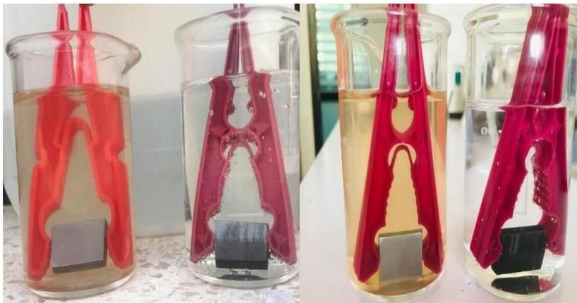
**Figure 2.8.** Echantillon de l'acier X70 immergé dans une solution avec et sans inhibiteur.
