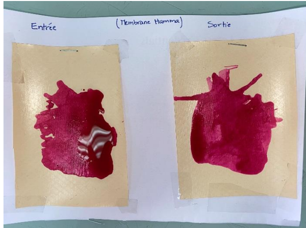
Figure III 2: Test d'intégrité à la Rhodamine ; (1)Fouka, (2)Maqtaa, (3)Hamma.
