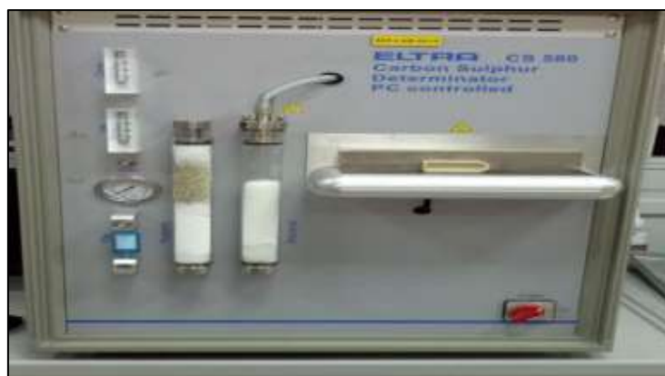
Figure I.16. Analyseur de carbone et de soufre ELTRA CS 580.
