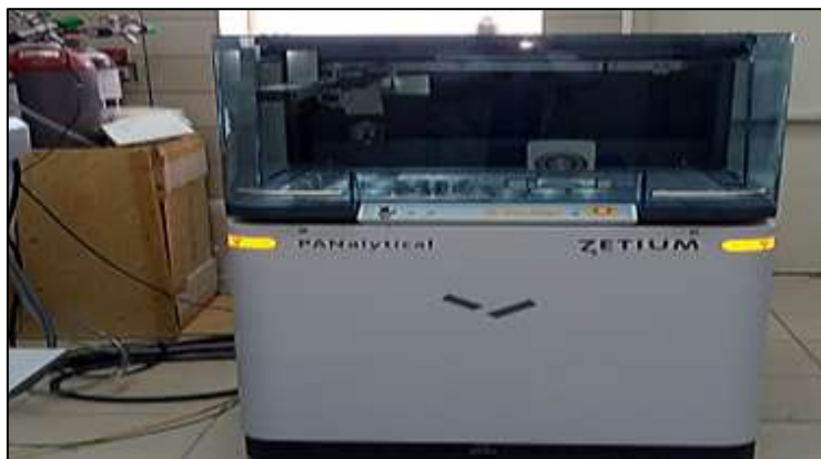
Figure I.17. Spectromètre rayons X PANalytical ZETIUM.
