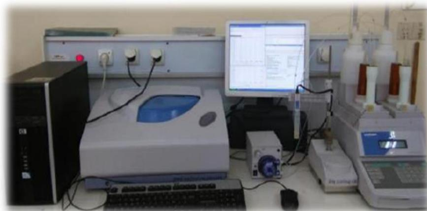
**Figure III.8** Appareil de Diffraction dynamique de la lumière SZ-100 (HORIBA-SCIENTIFIC).
