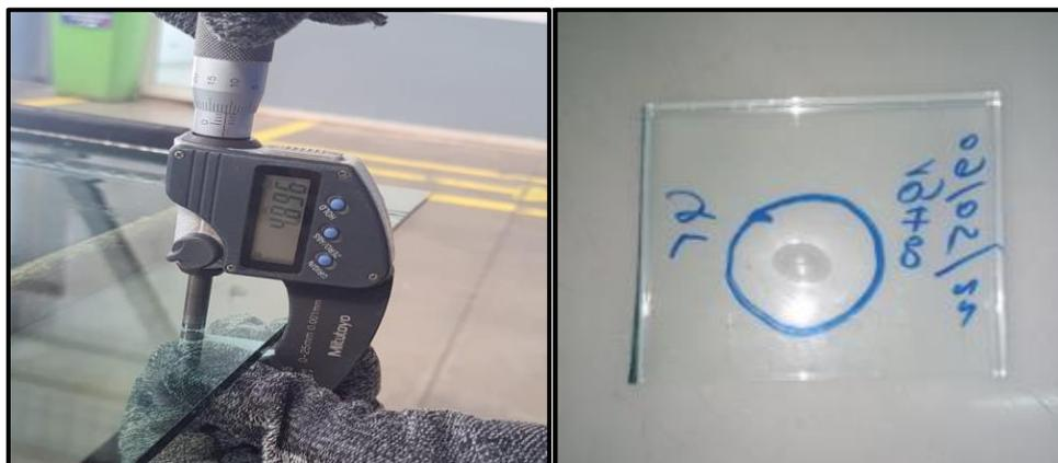
**Figure III.2:** Photographie représentant un échantillon du défaut (à droite) et son prélèvement (à gauche).
