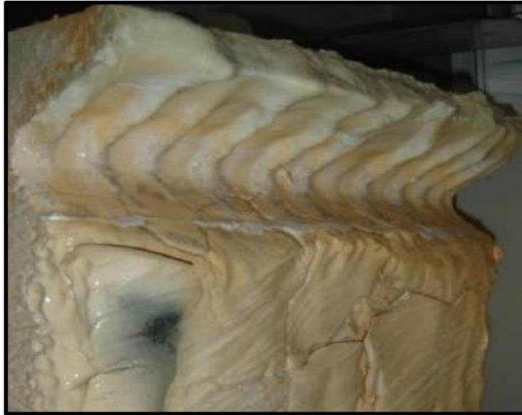
**Figure IV.13:** Photo présentant une brique réfractaire corrodée.
