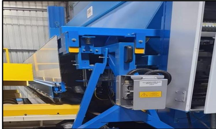
**Figure III.1:** Photographie présentant un appareil d'inspection (ISRA vision).
