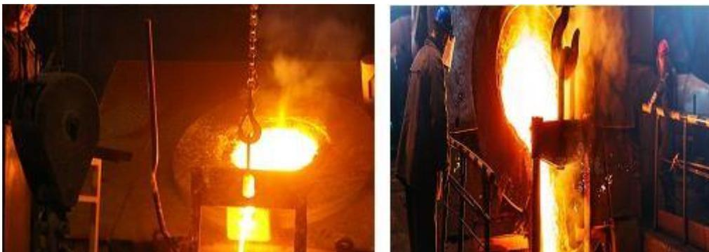
**Figure 2.7** : Coulée du cuivre après purification.
