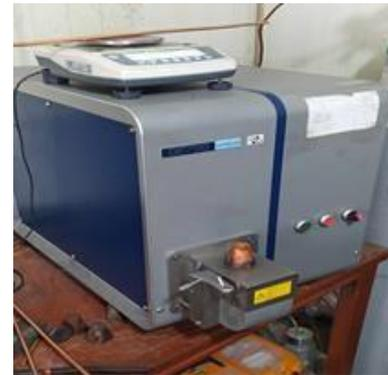
**Figure 3.1 :** Spectrophotomètre FOUNDRY-MASTER Xpert
