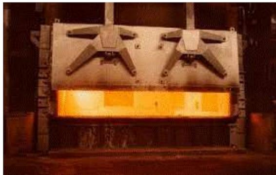
**Figure 2.6 :** four de fusion du cuivre au niveau de Arab Metals spa.
