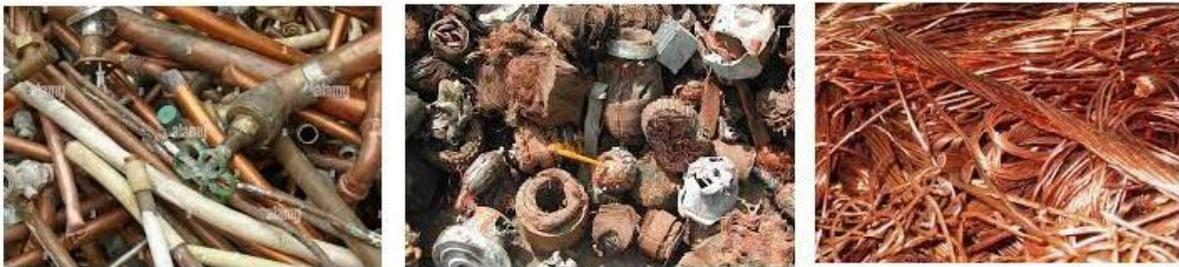
**Figure 2.1** : Déchets de cuivre issus de plomberie, moteurs électriques et câbles.
