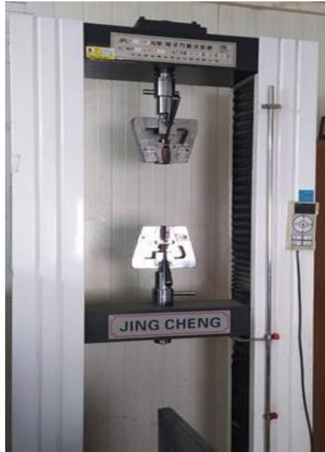
**Figure 3.3 :** Appareil pour test d'élongation.
