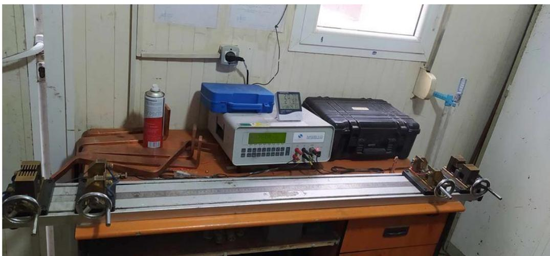
**Figure 3.4 :** Test Micro-Ohmmètre.
