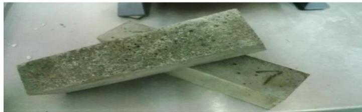
**Figure IV.3 :** Eprouvettes sans adjuvant.
