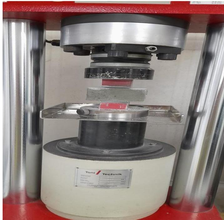
**Figure III.25:** Essai de résistance à la compression.
