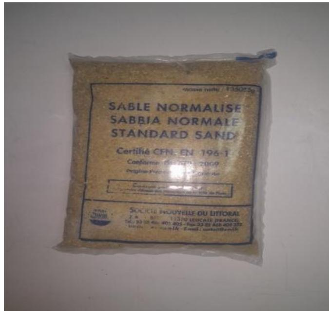
Figure III.1: Sable normalisé.
