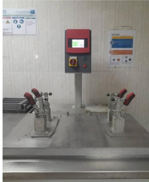
**Figure III.21 :** Appareil à chocs.
