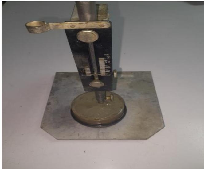
**Figure III.15 :** Pénétration de la sonde dans la pâte.
