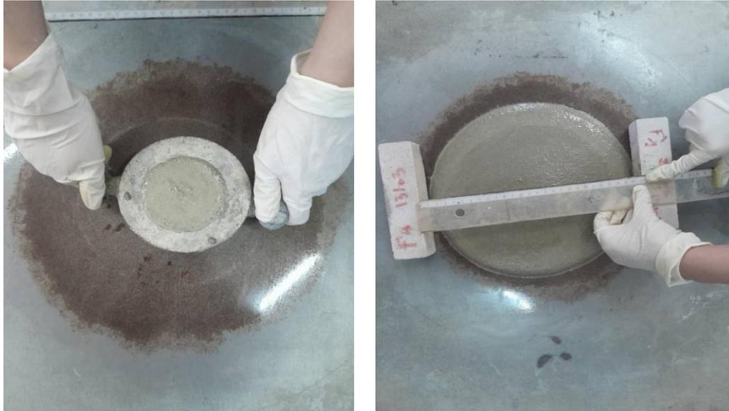
**Figure III.26** : Essai d'étalement pour mortier adjuvantés.
