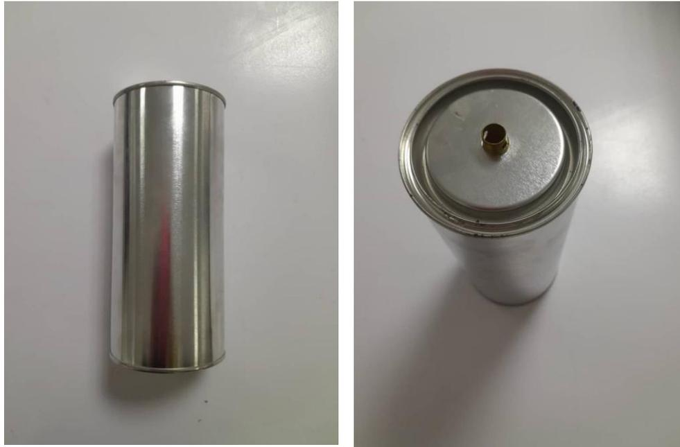
**Figure III.27** : Boîte à mortier.
