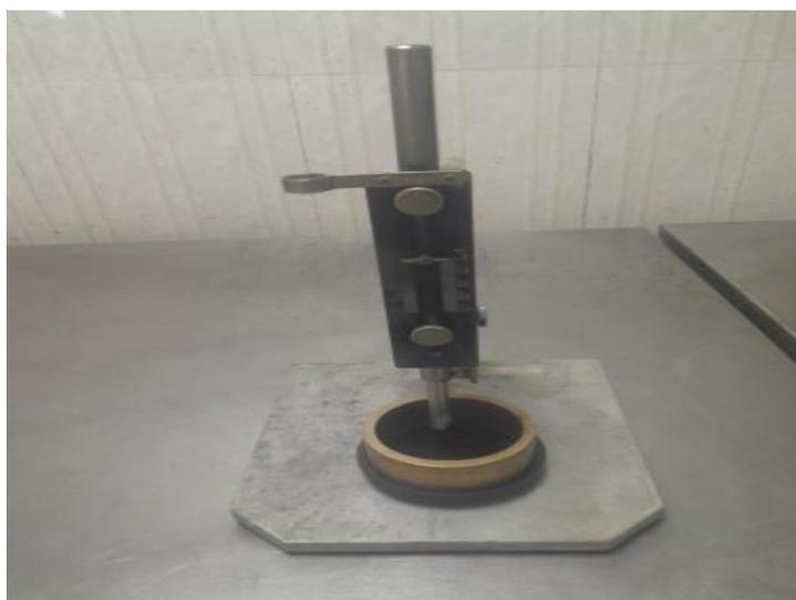
**Figure III.14 :** Appareil de Vicat.
