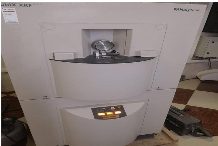
**Figure III.12 :** Appareil d'analyse XRF.
