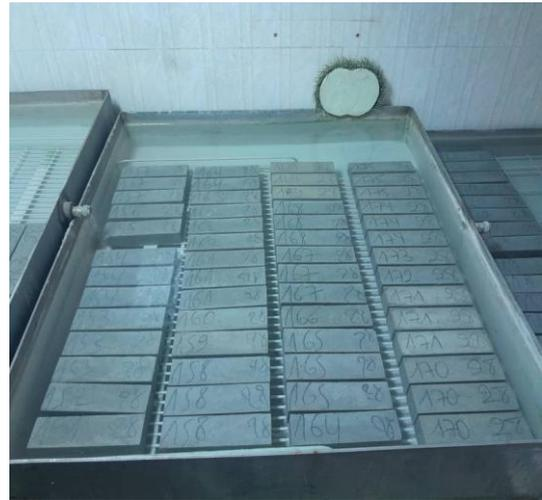
Figure III.24: Bain des éprouvettes.
