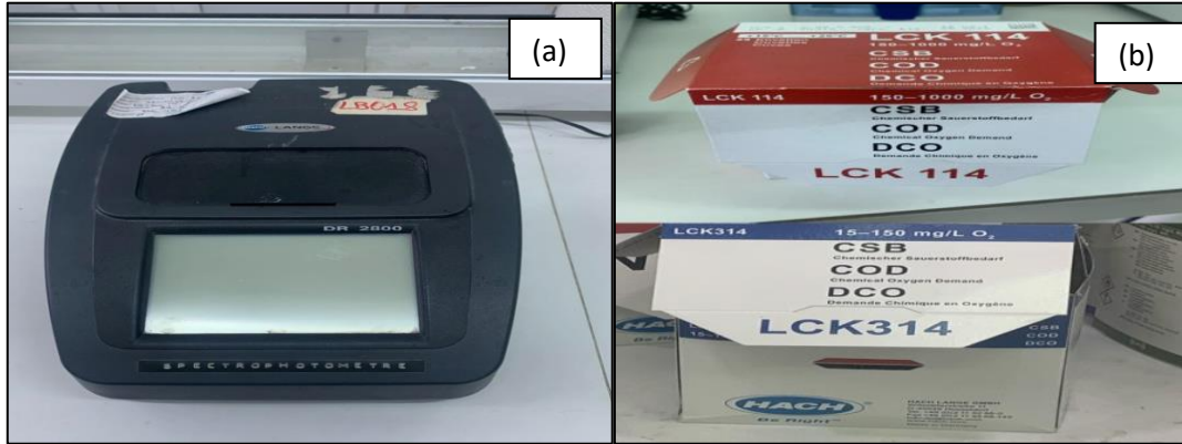
Figure III.7. (a) Spectrophotomètre ; (b) Réactifs d'analyse de la DCO
