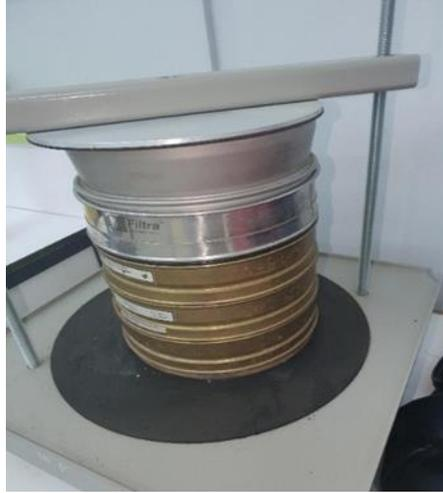
**Figure II.1 la tamiseuse utilisée dans l'opération de l'étude granulométrique.**
