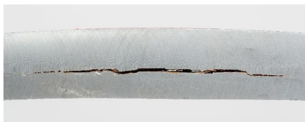
Figure I.9: Fragilisation par hydrogène d'un tube métallique.
