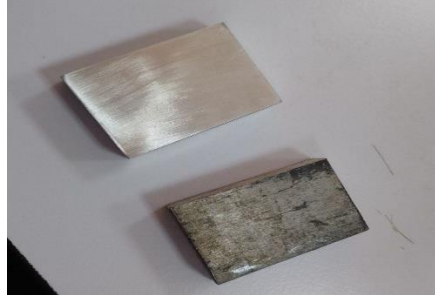
Figure II.6 : Echantillons avant et après polissage.
