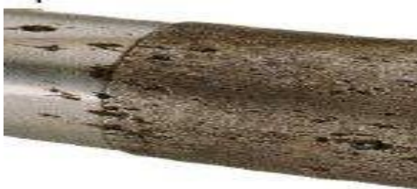
Figure I.4 : Corrosion par piquete [1].
