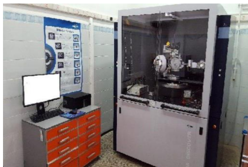
Figure II.12: Diffractomètre du type BRUKER Disc over D8.
