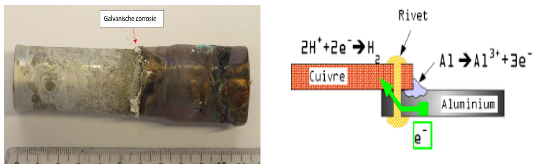
Figure I.8: Aspect et mécanisme de la corrosion galvanique.
