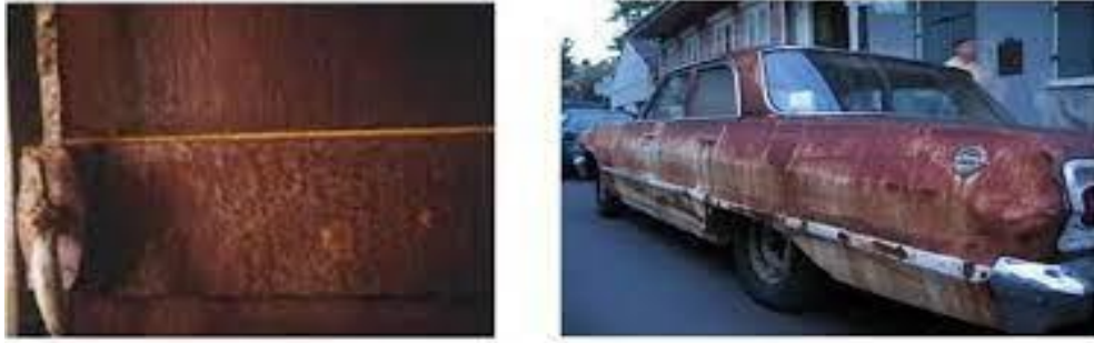
Figure I.3 : Corrosion uniforme : exemple d'une porte e un véhicule corrode [8].
