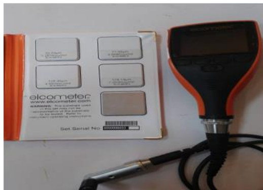
Figure II.10 : Appareil de mesure d'épaisseur par induction magnétique.
