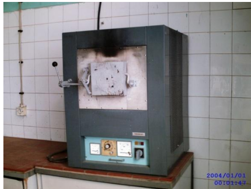
Figure 52. : Four de traitements thermiques.
