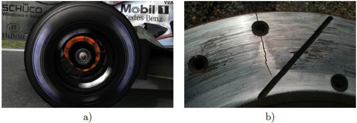
Figure 32. : a) Dissipation thermique due au frottement dans un disque de formule 1 b) Disque de frein usé par frottement [44].
