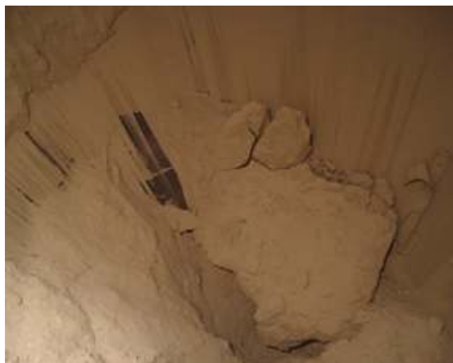
Figure IV.9 : Phénomène d'obstruction dans le silo de sable.
