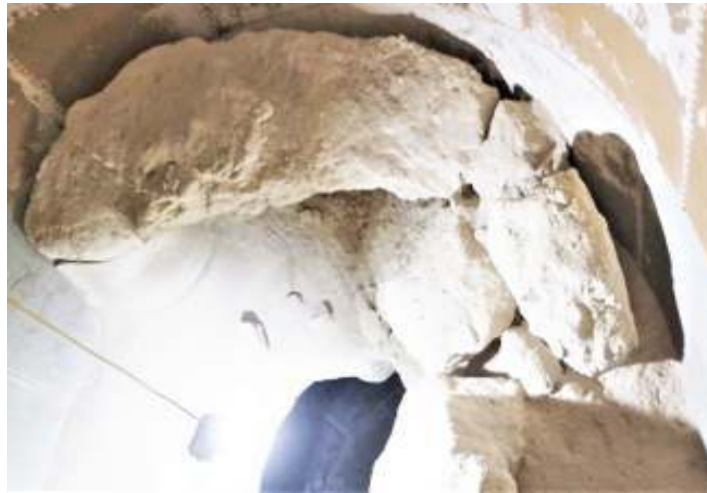
Figure IV.12 : Formation des blocs dans le silo.
