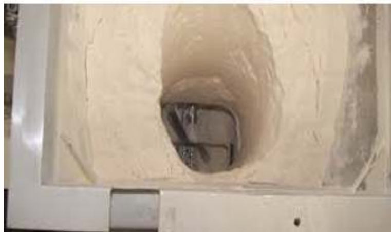
Figure IV.10 : Formation des entonnoirs dans les silos.
