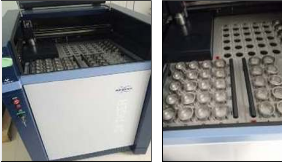
Figure III.2 : Photo d'un spectro-analyseur de type BRUKER S8 TIGER.
