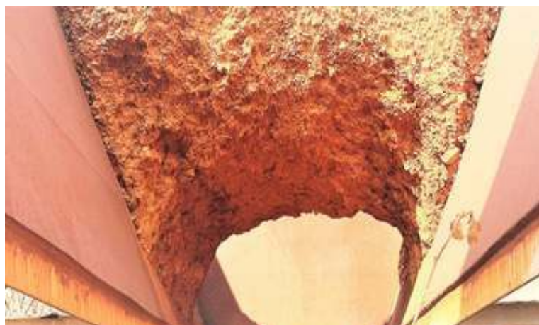
Figure IV.11 : Formation des ponts dans les silos.
