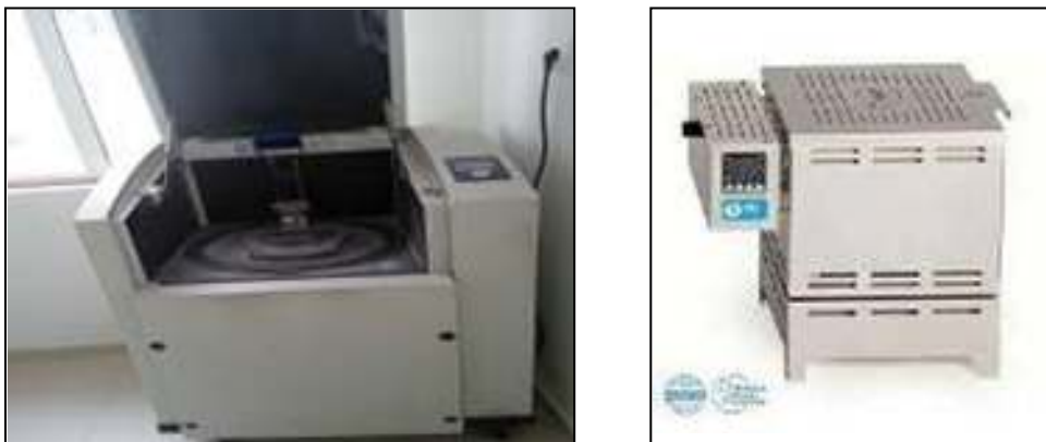
Figure III. 3 : Vibro-broyeur à disque RS 200 et four Minifuse.
