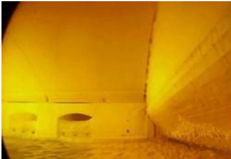
Figure IV.18 : Zone d'échauffement dans les parois du four avec accumulation de particules fines.
