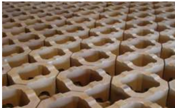
Figure IV.14 : Brique d'empilage dans les régénérateurs.
