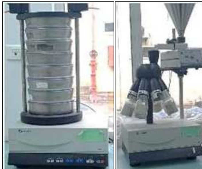
Figure III.1: Tamiseur de type Retsch AS200 et diviseur rotatif de type Retsch PT100.
