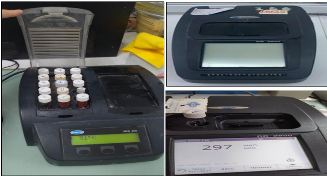
Figure II.5. (a) Bloc de chauffage à 150°C ; (b) Spectrophotomètre
