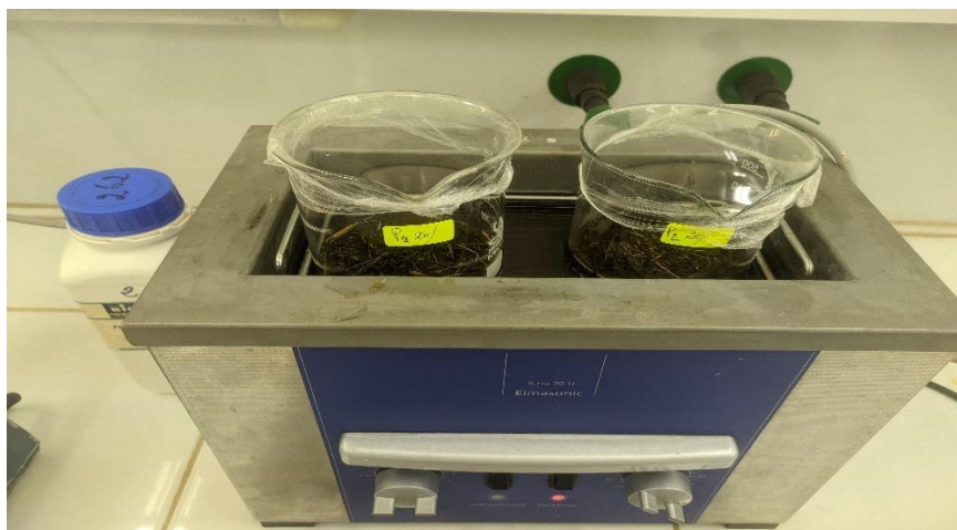
Figure 3.5 : Extraction par le bain ultrasons.
