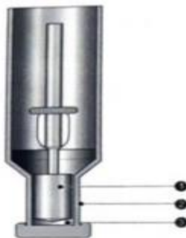
Figure 7.5 . Système de mesure Cup et Bob (cylindres coaxiaux)
