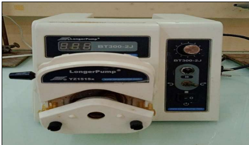
Figure. II.2. Pompe analogique péristaltique
