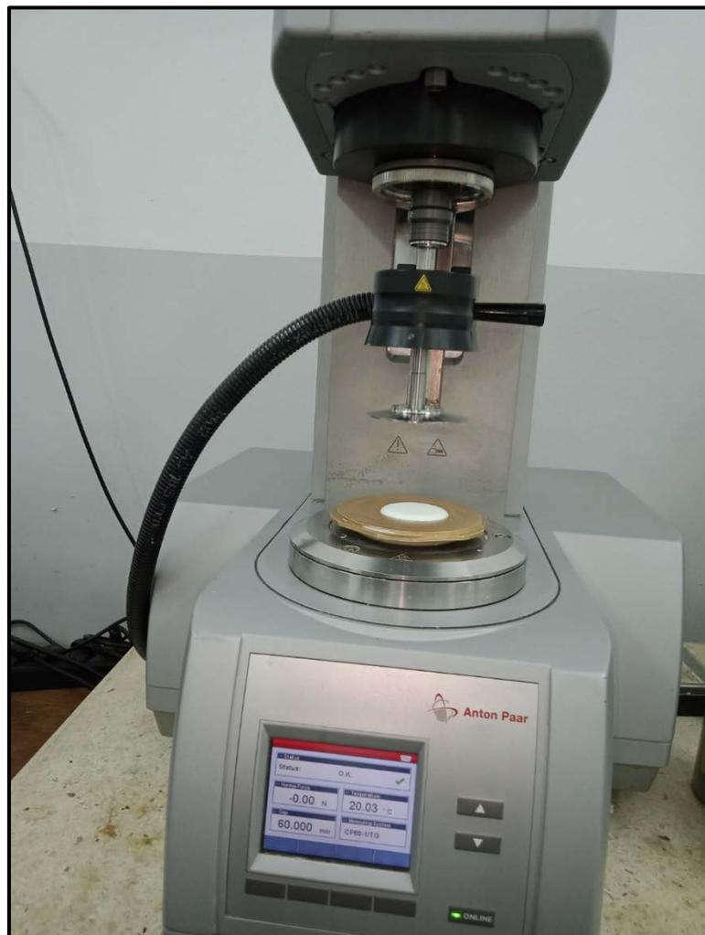
**Figure 3.3 : Rhéomètre**
