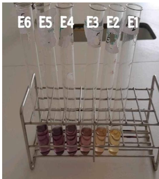
Figure 18 . Variation de la couleur de DPPH à différentes concentrations de Thymus vulgaris .
