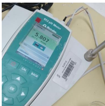
Figure 33. Mesurer le PH pour les deux formules de l'émulgel préparés à base de Thymus vulgaris
