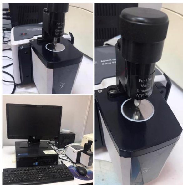
Figure II.2: l'appareil du spectromètre infrarouge à transformée de Fourier-ATR
