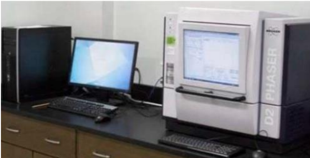
Figure II.4 : L'appareil de la diffractomètre par rayon X de type BRUKER D_2 PHASER 2G.
