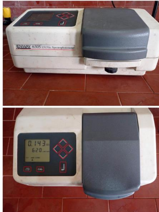
Figure II.6 : l'appareille de la spectroscopie UV-visible de type « JENWAY 6305 UV/Vis ».
