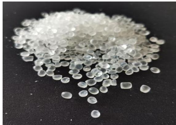
**Figure I.10:** Granulés d'EVA conçus pour être mis en forme.
