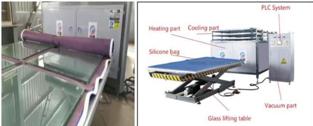
**Figure I.11:** machine de laminage sous vide
