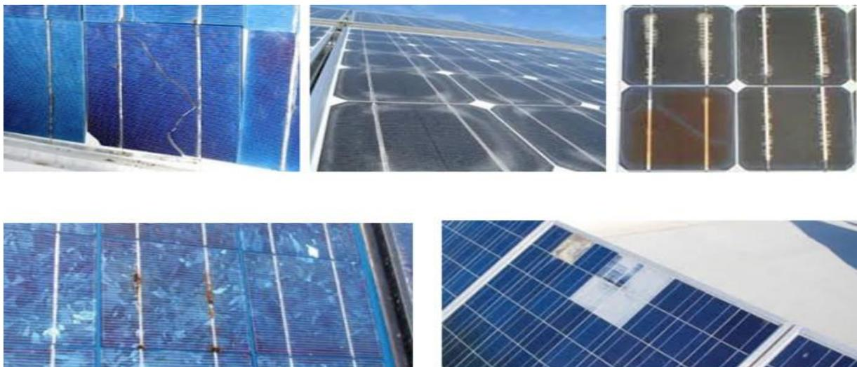
**Figure I.12:** les types de dégradation de l'EVA.
