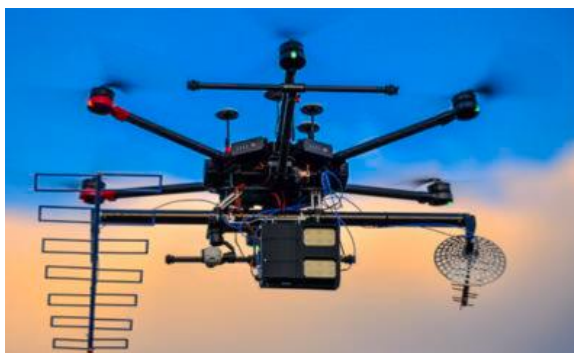
Figure 3-3: un exemple d'UAV-SAR équipé d'antennes en bandes P.C et L [29].
