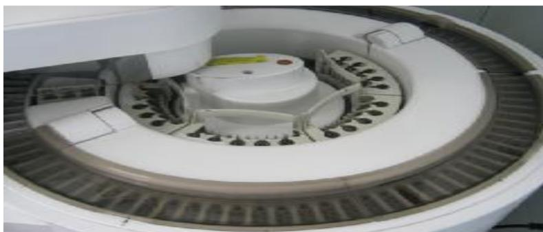
**Figure16** :L'unité d'échantillonnage
