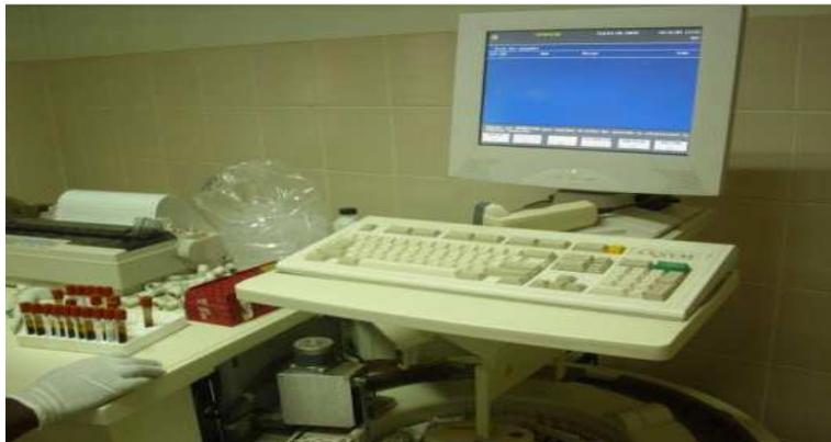
**Figure15** : appareillage de l'automate l'AXSYM
