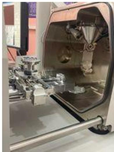
**Figure II.10:** microscope électronique à balayage quanta 650.
