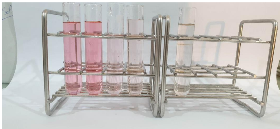
Figure 26: La décoloration de la solution de safranine en fonction de temps ( C= 8 ppm à \text{pH}=10 , m= 0.02\text{g} ) en catalyseur \text{Ni/MgO-CeO}_2 exposé aux rayons solaires.
