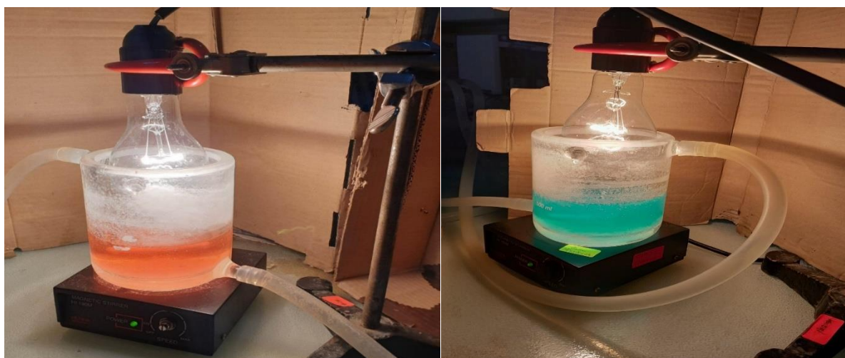
Figure 18: Ensemble de dégradation utilisé pour la photocatalyse.
