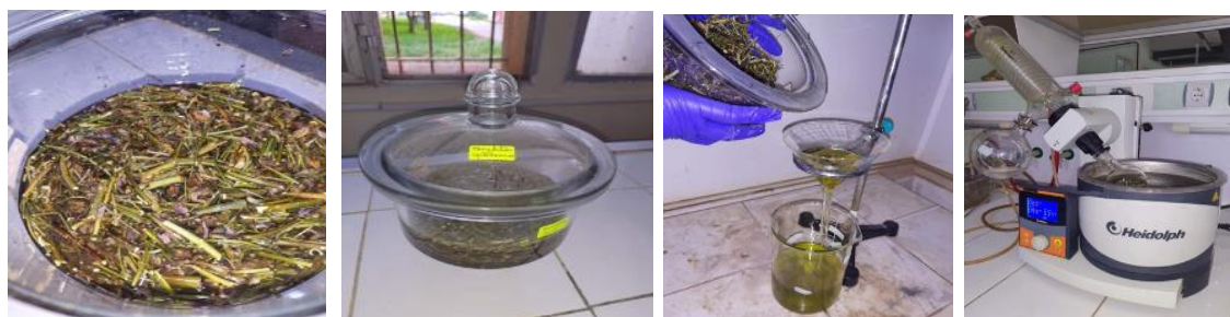
Figure II.1 : Les étapes d'extraction solide-liquide (Macération - Filtration - Evaporation).
