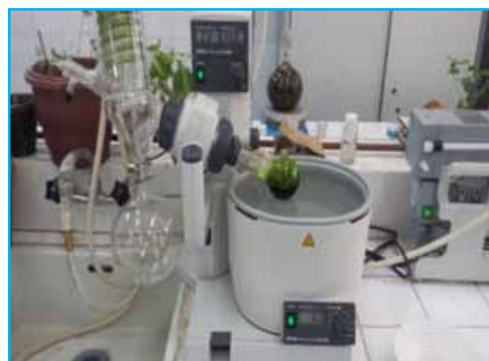
Figure 16. Rotavapor de type BÜCHI
